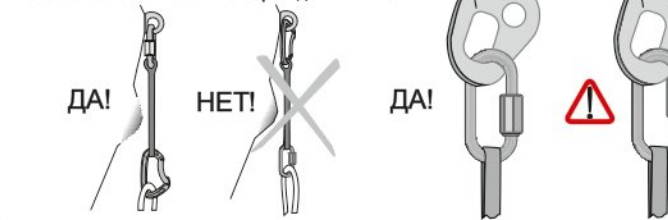
Рис. 6. Использование оттяжек с рапидами «Link 8»
